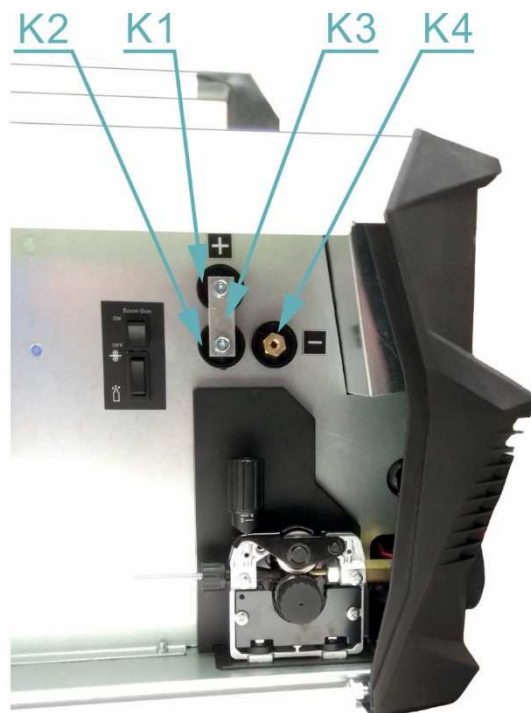
Obrázek 13. Detail terminálů změny polarity MIG/MAG hořáku
