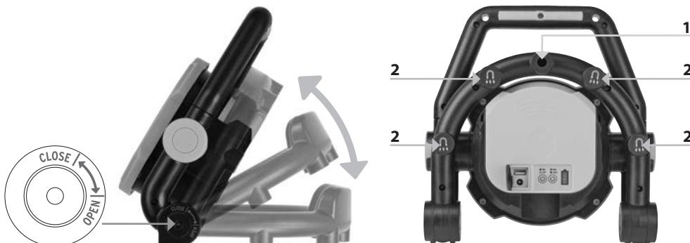
Zum Aufstellen kann die Akku-Leuchte in mehreren Stufen auseinander geklappt werden, aber nur maximal bis zur Markierung „OPEN“. Die Leuchte nicht mit Gewalt weiter auseinander klappen, da die Mechanik ansonsten beschädigt wird!
