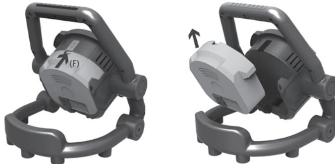
De batterij kan eenvoudig en snel worden vervangen. Druk daartoe de vergrendeling (F) naar voren en schuif de batterij er langs boven uit, zoals aangegeven. Op deze manier is het bv. mogelijk een batterij op te laden en tegelijkertijd met een aparte kopen hulpbatterij verder te werken.
