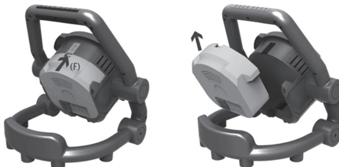
Аккумулятор можно заменить легко и быстро. Для этого нужно отжать вперед фиксатор (F) и выдвинуть аккумулятор вверх, см. чертеж. В результате можно, например, осуществлять зарядку аккумулятора и одновременно продолжать работать с использованием отдельно поставляемого запасного аккумулятора.
