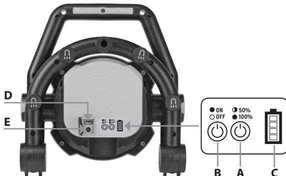
Om de lamp in te schakelen, op knop (B) drukken. Nu kunt u met knop (A) kiezen tussen een helderheid van 100% of 50%. Als u een helderheid van 50% instelt, blijft de lamp langer werken dan bij een helderheid van 100%, omdat minder energie wordt verbruikt. Om de lamp uit te schakelen, drukt u nogmaals op knop (B).
