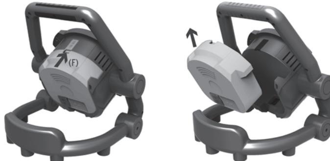
Der Akku kann einfach und schnell ausgetauscht werden. Dazu die Arretierung (F) nach vorne drücken und den Akku nach oben herausschieben, siehe Zeichnung. Somit ist es z.B. möglich, einen Akku aufzuladen und gleichzeitig mit einem separat erhältlichen Ersatzakku weiter zu arbeiten.
