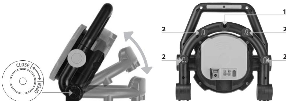
K instalaci lze akumulátorovou lampu rozložit ve více úrovních, ale maximálně po značku „OPEN“. Lampa se dále nemůže rozkládat s použitím násilí, nebo v opačném případě by se mohla poškodit mechanika!
