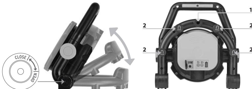
Para el montaje de la lámpara ésta puede plegarse en varios niveles aunque como máximo sólo hasta la marca "OPEN". ¡No fuerce la lámpara si no se puede plegar más, ya que podría dañar su mecánica!
