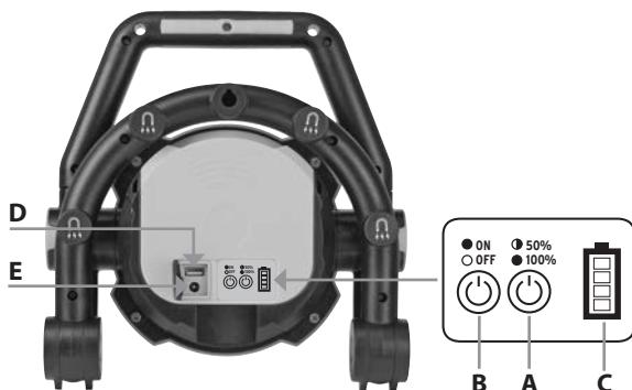
Для включения фонаря нужно привести в действие кнопку (B). После этого с помощью приведения в действие кнопки (A) можно выбрать яркость 100% и яркость 50%. При выборе состояния коммутации 50% длительность свечения по сравнению с состоянием коммутации 100% увеличивается, поскольку в этом случае расходуется меньше энергии. Для выключения нужно еще раз привести в действие кнопку (B).
