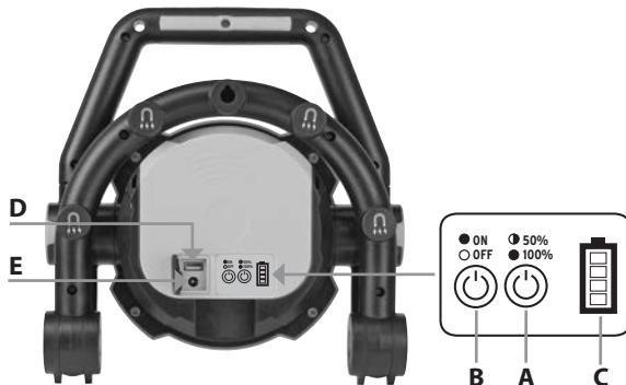
Para encender la lámpara presione la tecla (B). Ahora puede elegir entre un 100% o un 50% de luminosidad pulsando la tecla (A). Al seleccionar la opción del 50% la duración de iluminación se alarga en comparación con la opción del 100% ya que se consume menos energía. Para desactivar vuelva a presionar la tecla (B).
