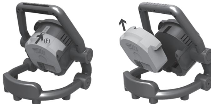
La batterie peut être facilement et rapidement remplacée. Pour ce faire, poussez l'élément (F) vers l'avant et tirez la batterie vers le haut (voir illustration). Il est ainsi possible de charger une batterie tout en continuant à travailler avec une autre batterie (vendue séparément).
