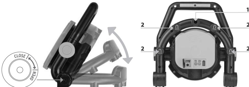
Dans le cadre de l'installation, ce projecteur peut être déplié en plusieurs étapes, au maximum jusqu'à la marque "OPEN". Ne forcez pas pour tenter de déplier davantage le projecteur sous peine d'endommager le mécanisme !
