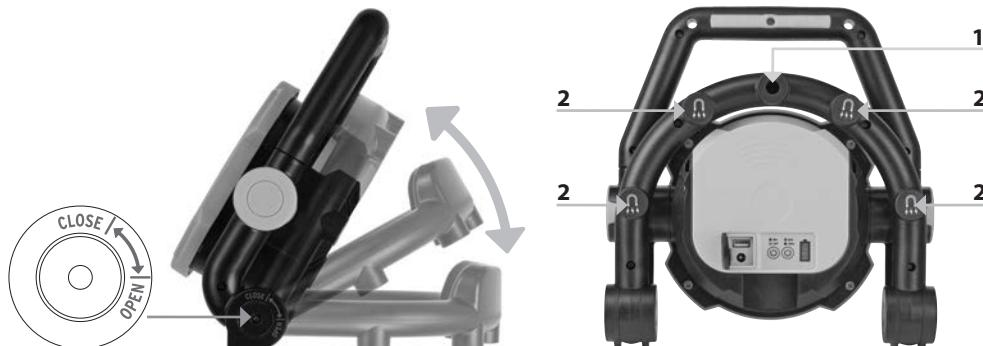
Akkuvalaisin voidaan taittaa useaan asentoon, mutta korkeintaan merkintään OPEN asti. Älä taita valaisinta voimakeinoiin auki, koska sen mekanismi voi vahingoittua sen johdosta! Valaisin voidaan tarvittaessa myös ripustaa rungossa olevan kiinnitysaukon (1) avulla koukkuun tai kiinnittää magneeteilla (2) metallipintaan. Tuotteen vahingoitumisen tai henkilövahinkojen estämiseksi on ehdottomasti varmistettava, että kiinnitys on luja.
