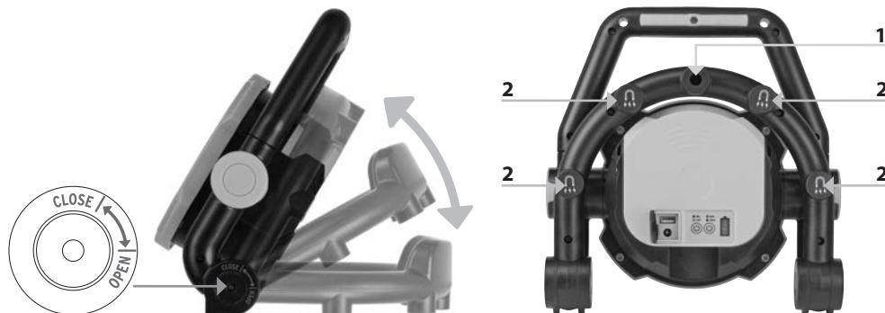
Om de batterijgedreven op te stellen, kan u hem in meerdere trappen openklappen, maar slechts tot de markering "OPEN". Gebruik geen overmachtige kracht om de spot open te klappen, want dat kan het mechanisme beschadigen!
