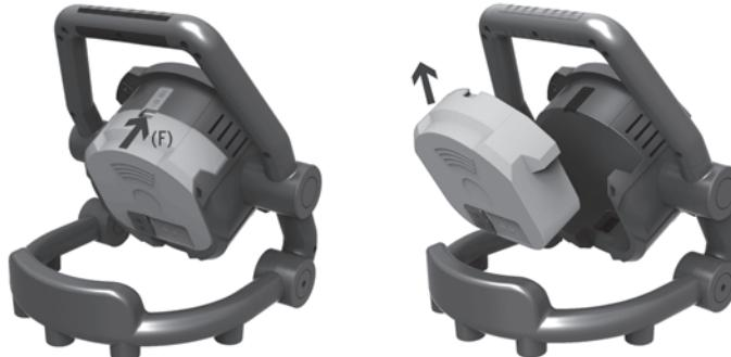
La batteria può essere sostituita in modo semplice e veloce. Per farlo, premere in avanti il bloccaggio (F) e spingere fuori verso l'alto la batteria ricaricabile, vedi illustrazione. In tal modo è possibile p.es. caricare una batteria e continuare a lavorare al contempo con una batteria di ricambio disponibile separatamente.
