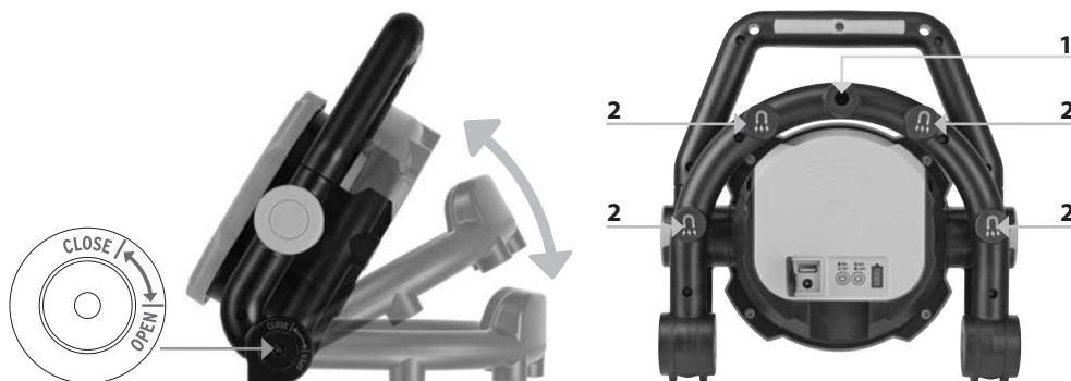
Durante o processo de instalação, o candeeiro sem fios pode ser desdobrado em vários níveis, mas apenas até a marca "OPEN". Não desdobrar o candeeiro com força, pois poderá danificar o seu mecanismo!
