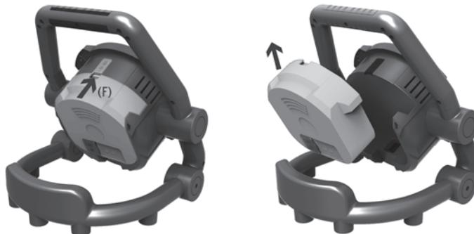
Akumulátor lze snadno a rychle vyměnit. K tomu zatlačte zablokování (F) dopředu a vysuňte akumulátor nahoru, viz kresba. Tak je např. možné nabít akumulátor a současná práce s náhradním akumulátorem, který lze separátně zakoupit.
